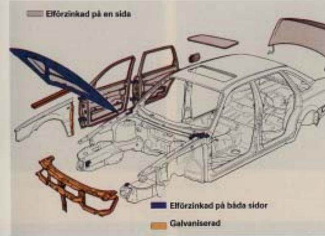
**Korrosionsskyddad karosseriplåt.** Karosseridetaler som är speciellt utsatta för rost är tillverkade i enkel- eller dubbelzijdig förzinkad plåt. Vissa särskilt utsatta detaljer är varm-förzinkade.
