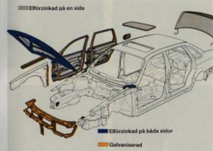
**Korrasionsskyddad karosseriplåt.** Karosseridetaljer som är speciellt utsatta för rost är tillverkade i enkel- eller dubbelsidig zinklackerad plåt. Vissa särskilt utsatta detaljer är varmförzinkade.
