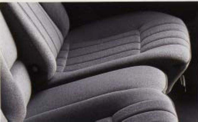
Baksätet i GL-modellerna kan sättas in 80 mm i längsled och är även delbart och helt fällbart till en eller två tredjedeler.
