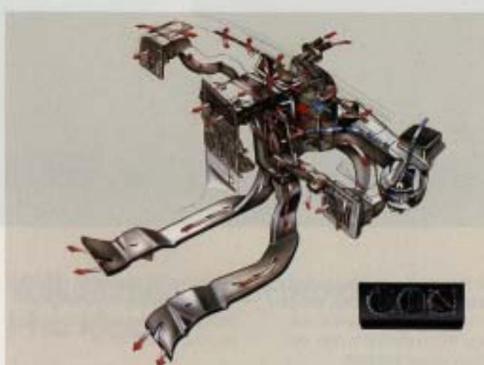
**Värme- och ventilationssystemet.** I nya Passat råder alltid ett skönt klimat – för både förare och passagerare. De nya värmevägen ger snabba och exakta inställningar och systemets funktion klarar sig inte påverkas varav sig av motorvarvt eller hastighet. I baksätet finns separata värmeutsläpp.
