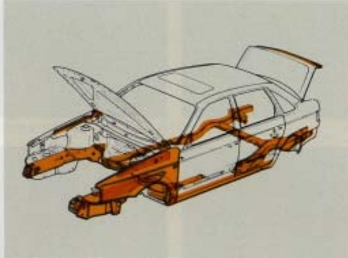
**Hölrumsbehandling.** Alla hålrum i karossen är behandlade med heta vax som sprutas in med en effektiv och helautomatisk process. Det skyddande vattnet når därfor in överallt.
