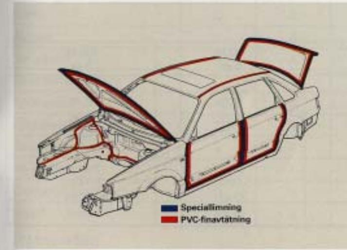
**Antitid mot rost.** På speciellt utsatta ställen som t.ex. invändiga fälgar i motorhus, dörrar och baksäckar är plåtdetaljerna speciallimmade mot varandra. Dessutom är alla fogaer tätade med ett PVC-material som utestänger fukt och förhindrar rostbildning.
