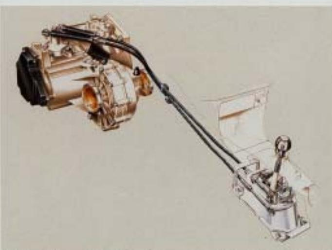
**Växelöverföring med vajrar.** Den nykonstruerade växellådan med växelöverföring via vajrar har mycket exakta växelflägen och är däremot mycket lättviktad. Tack vare den nya växelöverföringen fortfarande inte resonansslud i kupén och växelspelet gör sig inte tillsammans med drivaggregatet.
