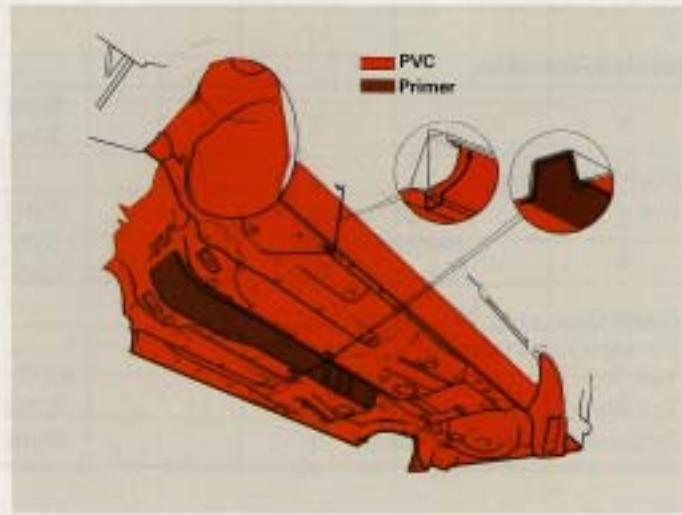
**Underredsbehandling.** Hela undersidan inklusive hjulhusen är specialbehandlade mot slag av stenar samt fukt. Bottenplattan är behandlad med ett hållbart och elastiskt skikt av PVC-material. Svetspunkter och fälgar är dessutom behandlade med en speciell rostskyddande primer.
