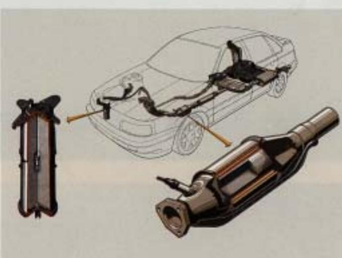
**Katalysator.** Samtliga versioner av nya Passat är utrustade med katalysator. Katalysatorn startar och påskyndar en kemisk reaktion som omvandlar de giftiga beständsdelarna till mer ofarliga ämnen. Med den här tekniken reduceras de giftiga beständsdelarna till ett minimum.
