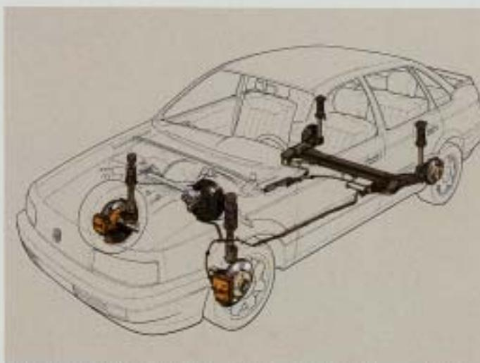
**Bromssystemet.** 107 och 136 hk versionerna av nya Passat har skivbromsar på alla fyra hjulen. De främre skivorna är dessutom invändigt kydla vilket förhindrar överhettning vid hårdare bromsningsar. För att öka säkerheten ytterligare kan samtliga versioner förses med lastningsfria bromsar (ABS).
