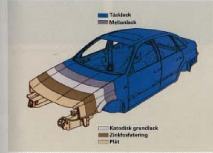
**Lackeringen.** Rikarossen tvättas först grundligt i ett dopbad. I ett påföljande bad förs den sedan med ett skyddande zinklackshtälkt som i sin tur 10% av ett lagr korrosionskyddsslack som appliceras på katodisk väg. Före slutlackeringen läggts också ett lagr primer på som garanterar en hög kvalitet på lackeringen.
