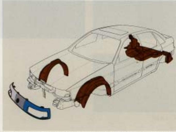
**Karosseridetaljer i syntetmaterial.** Bränsletanken och frontpartiet, som är speciellt utsatta för stenskott, är tillverkade av syntetmaterial. Extra innerskärmar av syntetmaterial skyddar också de främre hjulhusen.
