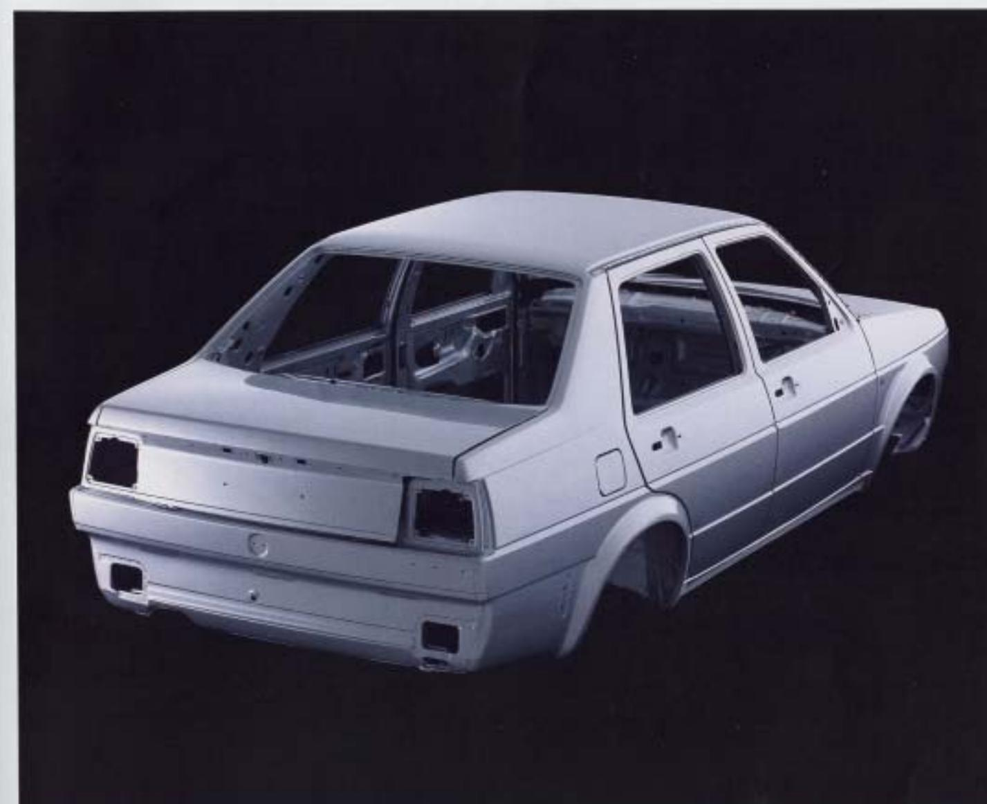
**Korrasjonsskyddad kaross.** De delar av karossen som är särskilt utsatta för rost, som tex innarpålan på motorhuven, är tillverkad i förzinkad plåt. Alla de nedre högigheterna i karosseriet, dörrarna och bakluckans baksida behandlas med hettvax som sprutas in i en offaktiv halautomatisk process. På så sätt när vaxet biver den mest avlägsna skrymslen och vrål.
