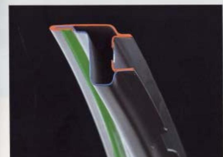
**Avtäckt mot rost.** På särskilt utsatta ställen, som tex invändiga fächer i motorhuv, dörrar och baklucka, specielltimsas plåtdetaljerna mot varandra. På så sätt förhindras kontaktkorrasjon mellan plåtarna. För att inte någon fukt skall kunna tränga in tittas fästena med PVC.
