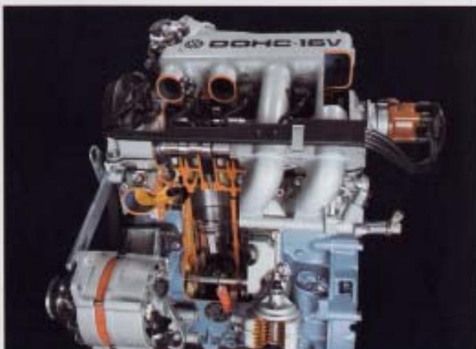
**16-ventilersmotorn.** Med hjälp av fyra ventiler till varje cylinder skapas ett betydligt större andningsrum för Jetta:s tvärställda, fyrcylindriga 1,8-liters GTI-motor, vilket också ger ännu bättre prestanda. Det avancerade bränsleinsprutningsystemet KE-Jetronic och de dubbla överliggande kamexhorna säkrar motorns fina gång vilket gör att den utvecklar 129 hk samtidigt som den accelererar 0–100 km/h på 8,3 sek.
