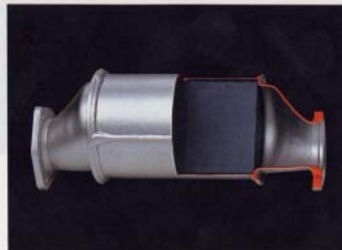
**Katalysator.** Sämliga Jetta är utrustade med katalysator. Katalysator startar och påskyndar en kemisk reaktion som omvandlar de giftiga beständsdelarna till mindre farliga ämnen. Katalysator är särskilt effektiv tillsammans med lambda-inställningen och reducerar de giftiga beständsdelarna i avgaserna till ett minimum.
