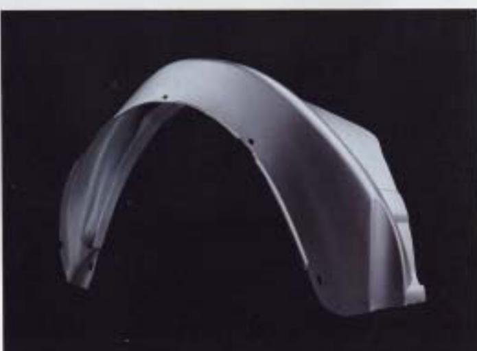
**Delar av plast och underredssbehandling.** De delar som är mest utsatta för stenskott, som tex de främre hjulhusen, är klädde i plast. Skarver, foder och färsar tillas. Slutligen förses hela det område av bottenplattan som är mest utsatt för stenskott med ett tjockt, hårt och elastiskt skikt av PVC-material.
