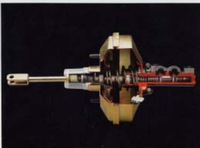
**Bromskraftförstärkare.** Med bromskraftförstärkaren bromsar man mjukt och säkert med obetydlig kraftförbrukning. Det undertryck som uppstår från motor i insugningsrör, utnyttjas genom bromskraftförstärkaren till att stötja pedalkrafen.
