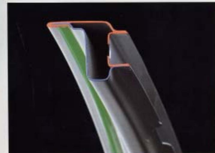
**Avtäckt mot rost.** På särskilt utsatta stål delar, som tex invändiga fälgar i motorhus, dörrar och baklucka, speciellt mas plåtdekaljerna mot varandra. På så sätt förbyggs kontaktkorrasjon mellan plåtarna. För att inte någon fukt skal kunna tränga in täts-fälsama med PVC.
