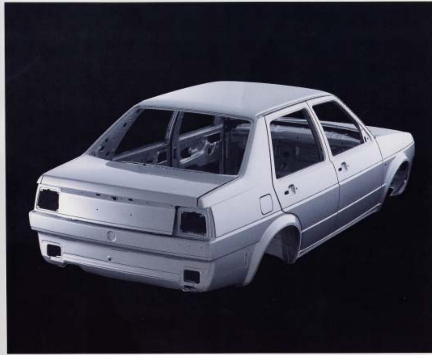
**Korrosions skyddad kaross.** De delar av karossen som är särskilt utsatta för rust, som tex innerplåten på motorhuven, är tillverkad i förzinkad plåt. Alla de nedre hängelikorna i karossen, dörrarna och bakluckan bakom del behandlas med henvax som sprutats in i en effektiv helsautomatisk process. På så sätt riks visat även de mest svaglägna skynnsolen och vriden.
