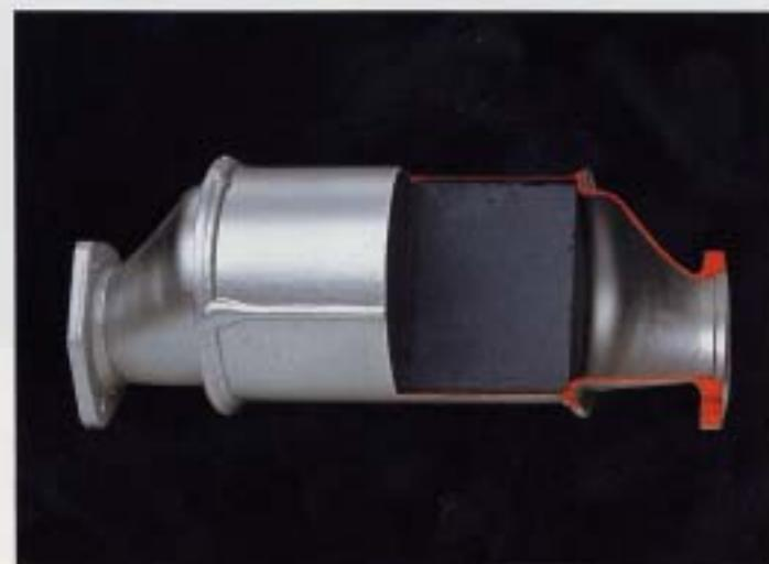
**Katalysator.** Samtliga Jetta är utrustade med katalysator. Katalysatorn startar och påskyndar en kemisk reaktion som omvandlar de giftiga beständsdelarna till mindre farligaämnen. Katalysatorn är särskilt effektiv tillsammans med lambda-inställningen och reducera de giftiga beständsdelarna i avgaserna till ett minimum.
