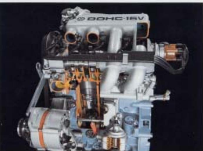
**16-ventilsmotor.** Med hjälp av fyra ventilar till varje cyylinder skapas ett betydligt större undervänjningsrum för Jetta:s tvärställda, fyrcylindrig 1,8-liters GTI-motor, vilket också ger ännu bättre prestanda. Det avancerade biänslänsprutningssystemet KE-Jetronic och de dubbla överliggande kamaxlarna siktar mot en fyra gång vilket gör att den utvecklar 129 hk samt accelererar 0–100 km/h på 9,3 sek.
