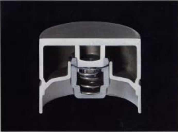
**Hydrauliska ventillyftare.** De hydrauliska kopplentyftarna kräver inte något underhåll och ger praktiskt taget vid varje kamavhöjdning ett korrekt ventilspeleum med alla fördelar som detta innebär vid varje insprutning.
